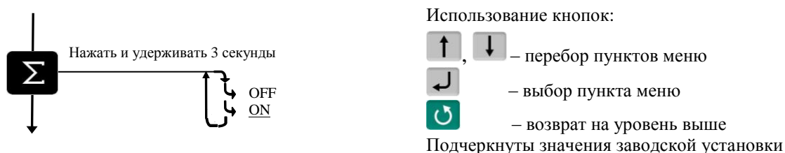
Рис. 4.2 - Схема включения/отключения встроенного принтера
